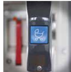
Für ein sicheres Aussteigen sind in den Sitz- und Stellbereichen Tasten mit einem Kinderwagensymbol angebracht. Die Benutzung zeigt dem Fahrpersonal an, dass die Türen in diesem Bereich länger für den Ausstieg geöffnet bleiben sollen.
